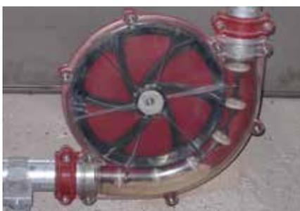
Speziell abgedichtete Kugellager sorgen für eine lange Lebensdauer der Umlenkecken. Die Ecken sind auch mit eigens für den Einsatz von CCM in der Futterration entwickelten Gleitlagern, in 45° bzw. 90° Ausführung oder aus hochwertigem Aluminium, für besondere Ansprüche, erhältlich.
