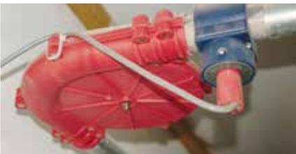
Der Sensor kann direkt an der letzten Dosierstelle angebracht werden. Es besteht auch die Möglichkeit, den Sensor am Förderrohr unmittelbar nach der letzten Futterstelle anzubringen. Spart Energie durch Vermeidung unnötiger Laufzeiten.
