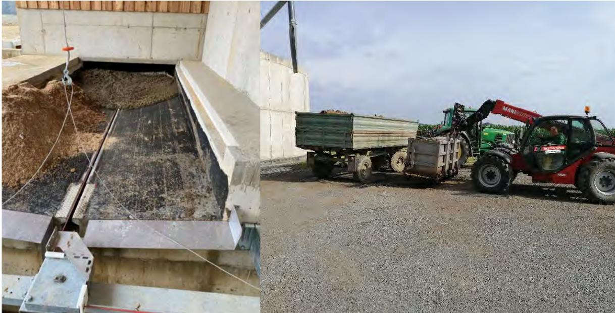
Abbildung 95: Entmistung (Schraper) mit Kot-Harn Trennung
