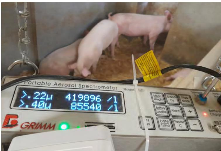
Abbildung 187: Grimm Aerosol Spektrometer während des Messvorganges
