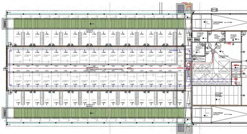
Abbildung 29: Grundriss des Stallgebäudes für 850 Tierplätze mit Funktionseinheiten (Plan: Fa. Lorber und Partner, Skizze: Fa. Schauer Agrotronic)
