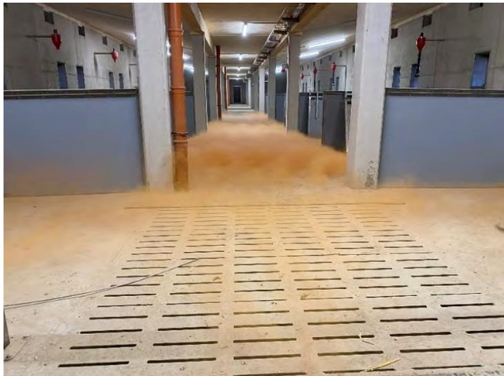
Abbildung 2: Stallinnenraum mit zuluftführendem Kontrollgang, Zuluft orange dargestellt, Liegebereich links und rechts mit verschiebbaren Buchtenrückwänden (Quelle: Raumberg-Gumpenstein)
