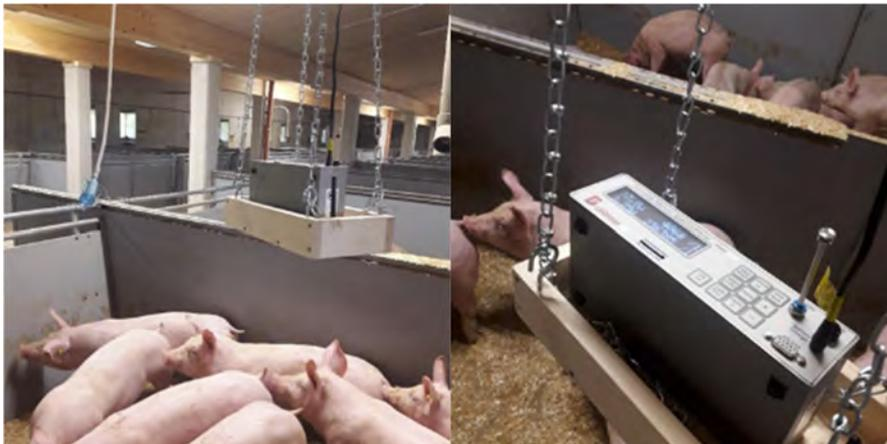
*Abbildung 169: Messkorb mit Spektrometer 11-C im Ruhebereich*
