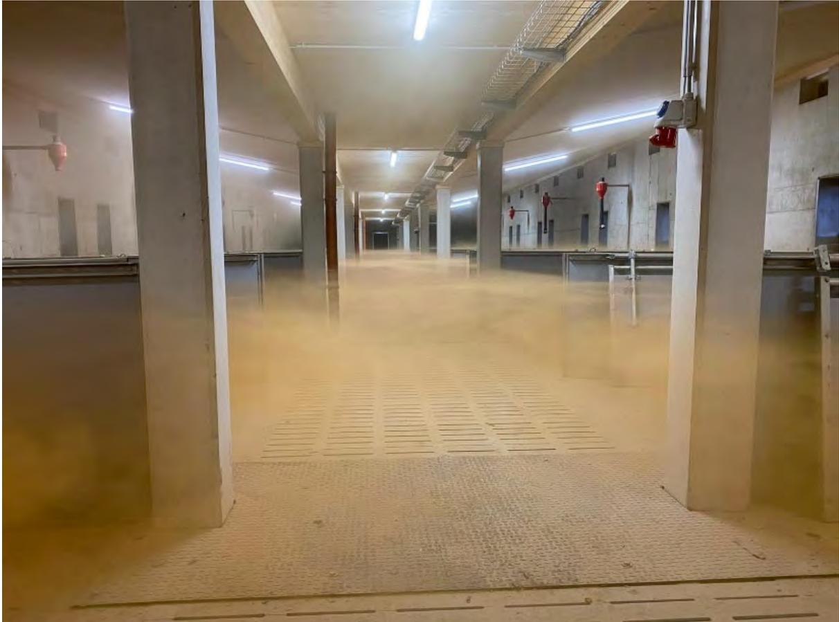
*Abbildung 32: Visualisierung der Zuluftführung mittels Vernebelung
