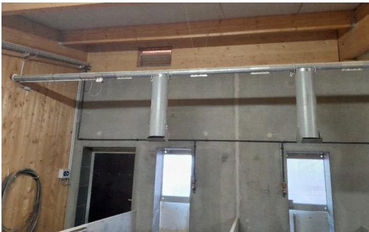
*Abbildung 182: Automatisierte Einbringung entstaubter Einstreu über eine Strohmatic light-Anlage*
