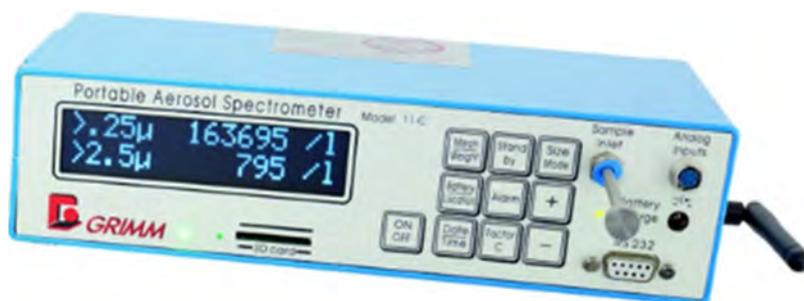
Abbildung 168: Grimm 11-C Aerosol-Spektrometer
