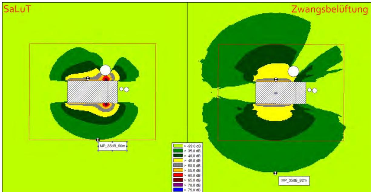
Abbildung 139: Flächenhafte Schallimmissionsberechnung des SaLu\_T-Stalles im Vergleich mit einem zwangsbelüfteten Stallsystem
