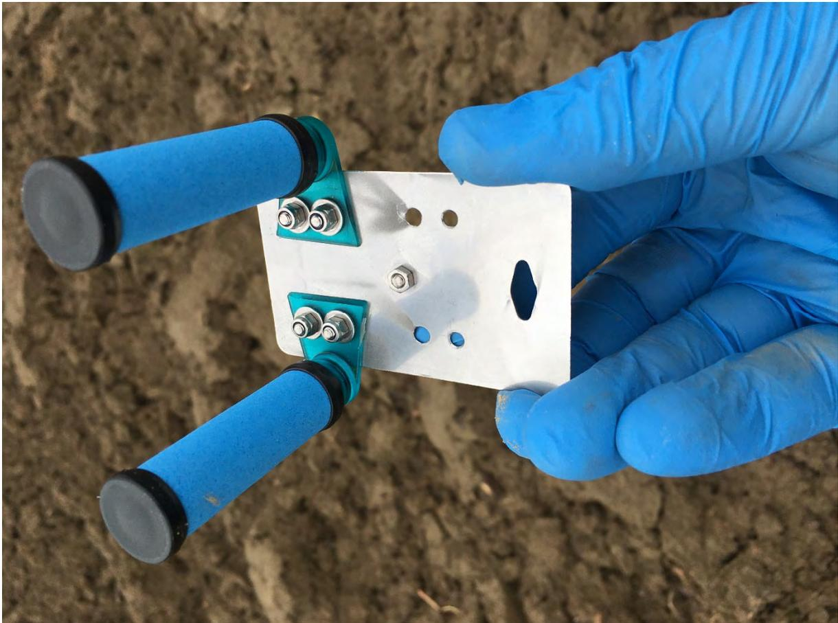
*Abbildung 126: Zwei Radiellos in den Diffusionskörpern zur Erhebung der Ammoniakbelastung*
