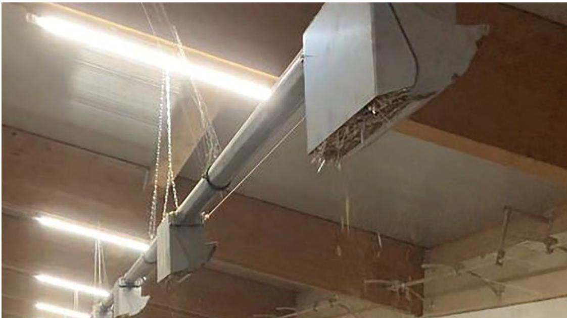
Abbildung 38: Vorratsbehälter mit Abwurfstelle für Mittellangstroh (Bildquelle: Fa. Schauer Agrotronic)
