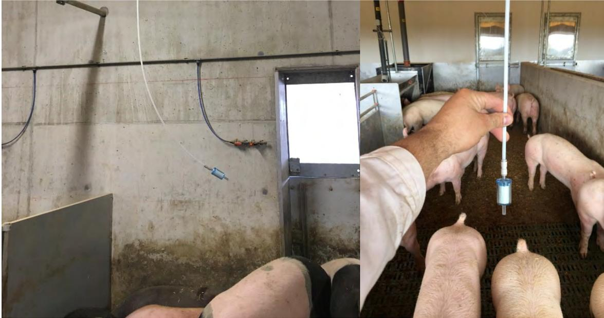
Abbildung 128 und Abbildung 129: Gasmessleitung mit Staubfilter im Ruhebereich der nördlichen Bucht und im Kotbereich
