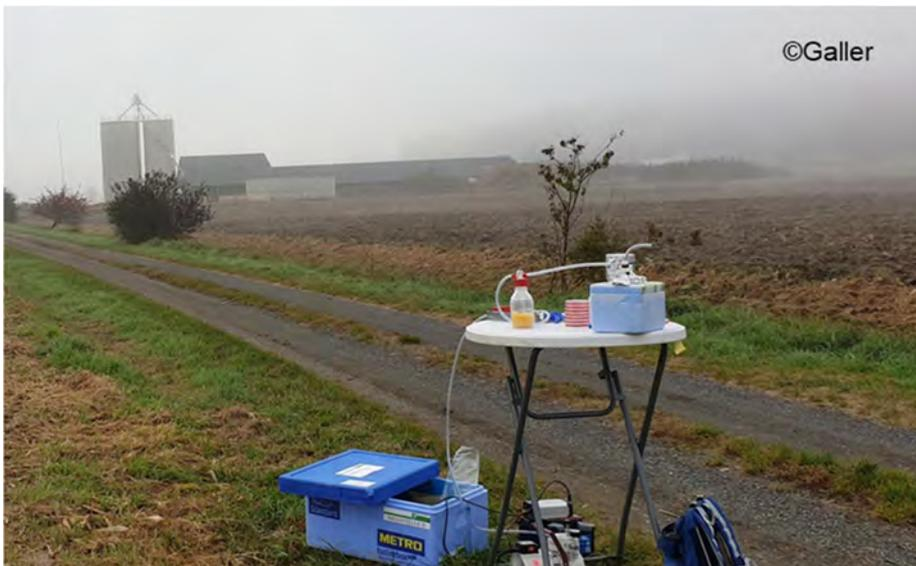
Abbildung 141: Beispiel einer Immissions- bzw. Hintergrundmessstelle
