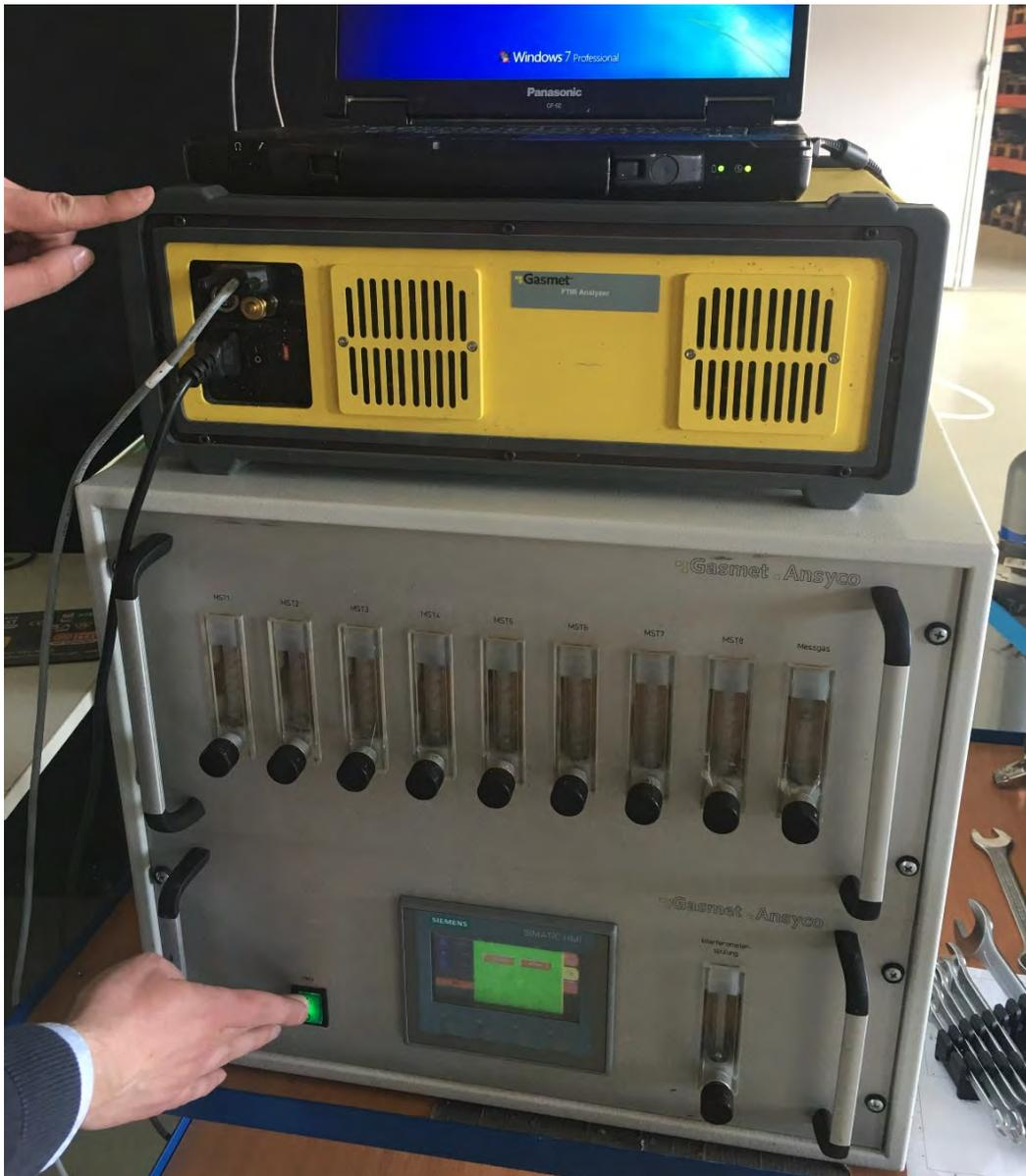
Abbildung 127: FTIR-Anlage der DLG Deutschland. Spektrometer + Sampler und Bedienungseinheit
