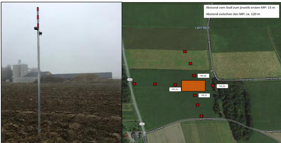
Abbildung 125: Eine von insgesamt 10 Messsäulen mit montierten Radiellos zur Ammoniakmessung sowie der Positionsplan mit den 10 Messpunkten (Zentner, 2020)
