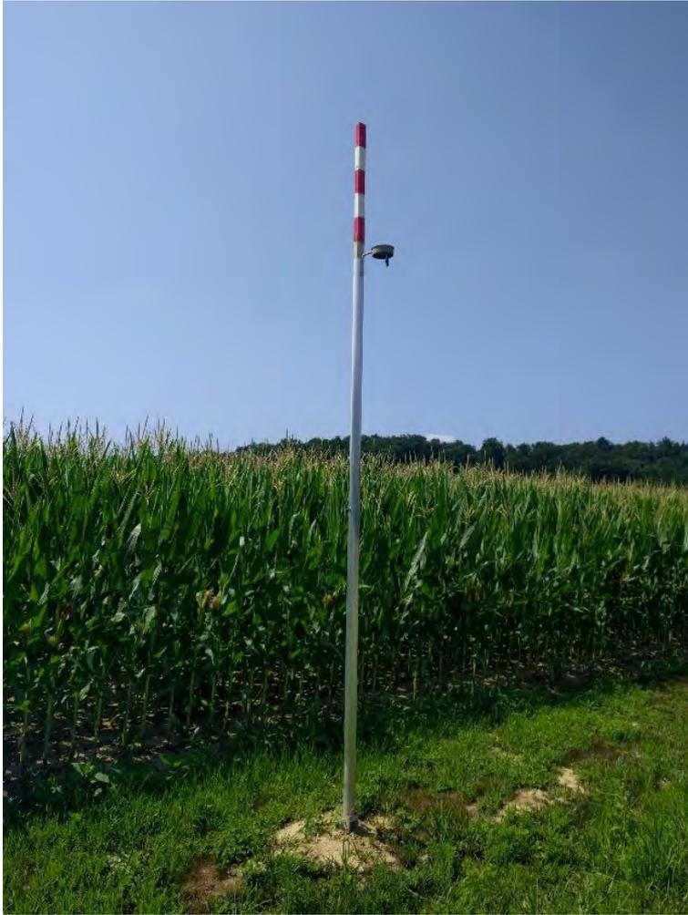
Abbildung 108: Sammlereinrichtung für die  $\text{NH}_3$ -Messung
