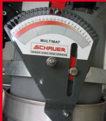
Rasterverstellung mit 24 Positionen für einfache Bedienung
